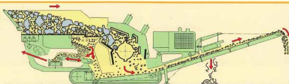
Flusso del materiale attraverso la macchina. Material flow throught the machine.
