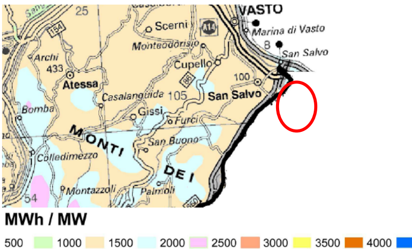
Figura 4: Producibilità specifica a 50 metri s.l.m. nell'area di Cupello (fonte Atlante Eolico dell'Italia - Cesi, Dipartimento di Fisica dell'Università di Genova)
