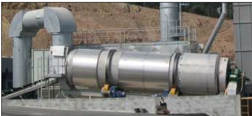
Fig. 2 - Essiccatore a tamburo rotante analogo all'esistente
